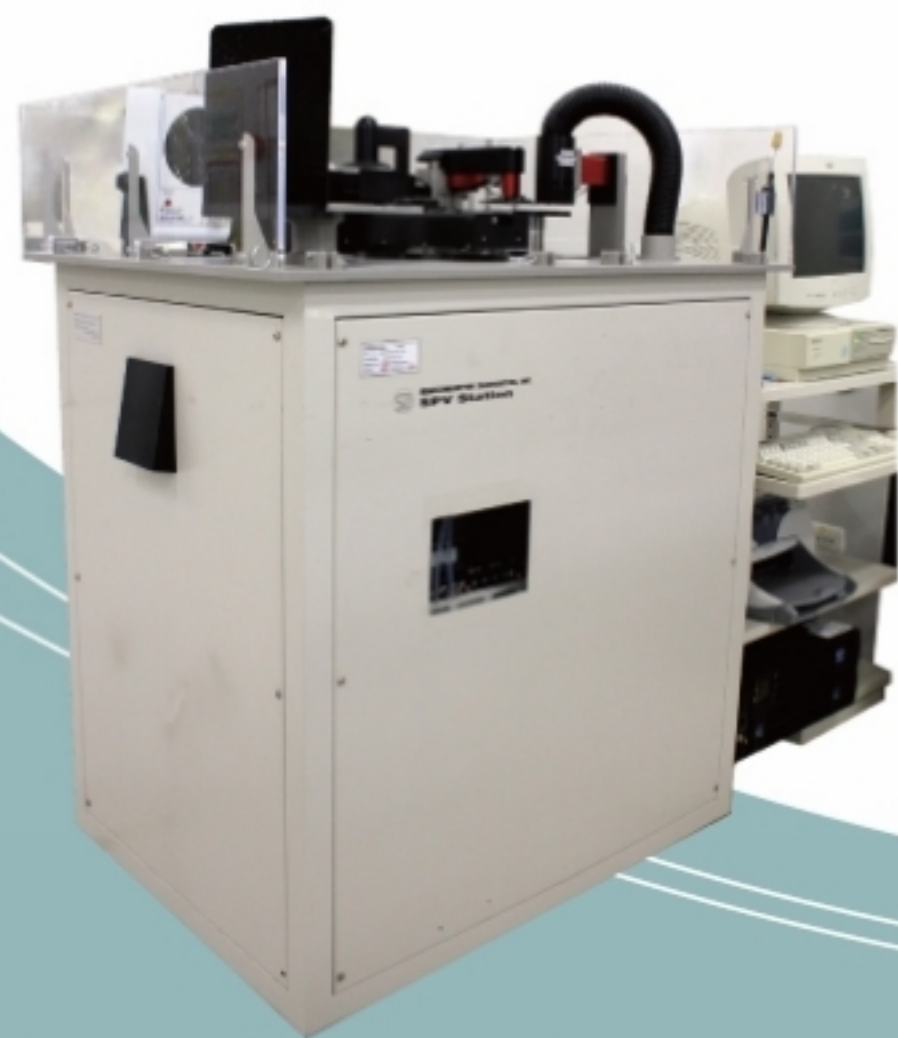
▲ C 重金属、寿命测定装置 SPV Heavy metal、Life time testing SPV
